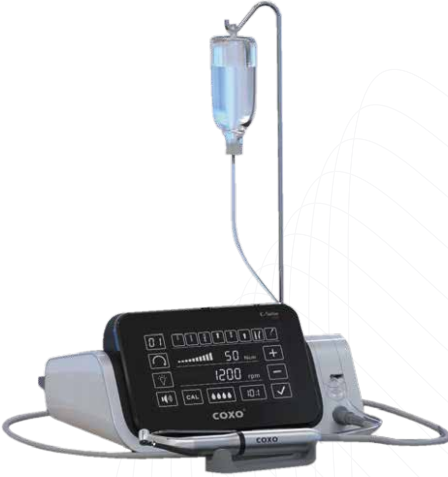
Fiber optik kontra aç 30000lux'a kadar yüksek parlaklıkta LED ışık kaynağı
